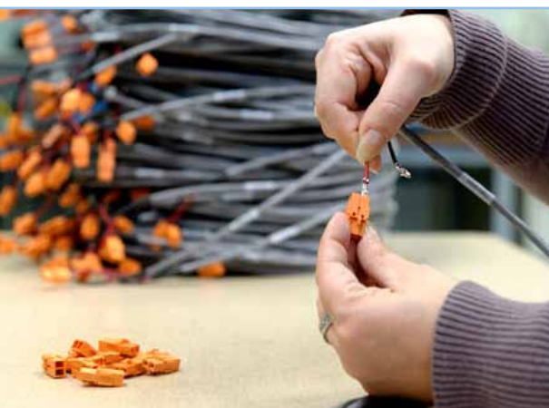
Het controleren en testen van elke afzonderlijke kabel behoort tot de werkzaamheden van deze afdeling.
